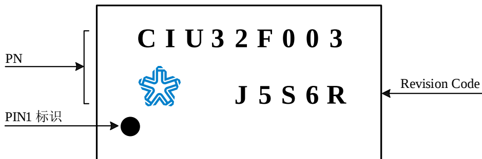
图 5-6 SOP8 封装丝印信息说明
